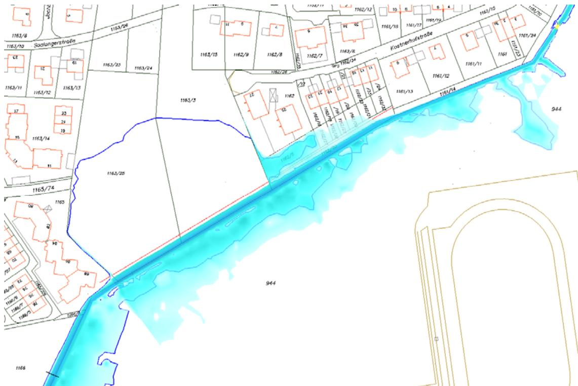
Abbildung 5.4: Überschwemmungsgebiete bei HQ<sub>100</sub> im Planungszustand mit Angabe des Rands der Überschwemmungsfläche im Istzustand.
