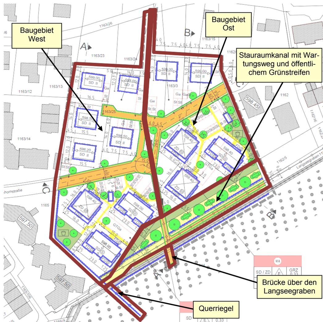
Abbildung 2.1: Lageplan zum aktuellen Entwurf des BBP Ahornstraße, Stand vom 02.12.2014 (Quelle: Baubüro Gumberger) mit Angabe der wesentlichen Baumaßnahmen
